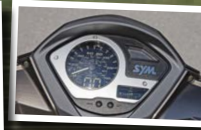
Ψηφιακός και πλήρης ο πίνακας οργάνων, με ένα πρωτότυπο τρόπο να βγάζει contrast, προβάλλοντας της πληροφορίες πάνω σε μαύρο φόντο.
