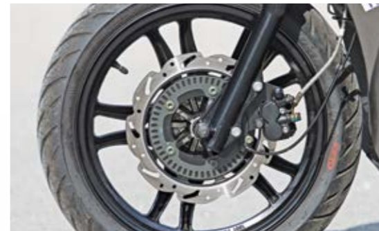
Η προσθήκη του ABS, αποτελεί την μεγαλύτερη αλλαγή στο νέο μοντέλο, ολοκληρώνοντας ένα σύστημα πέδησης του οποίου η απόδοση είναι πολύ καλή.
