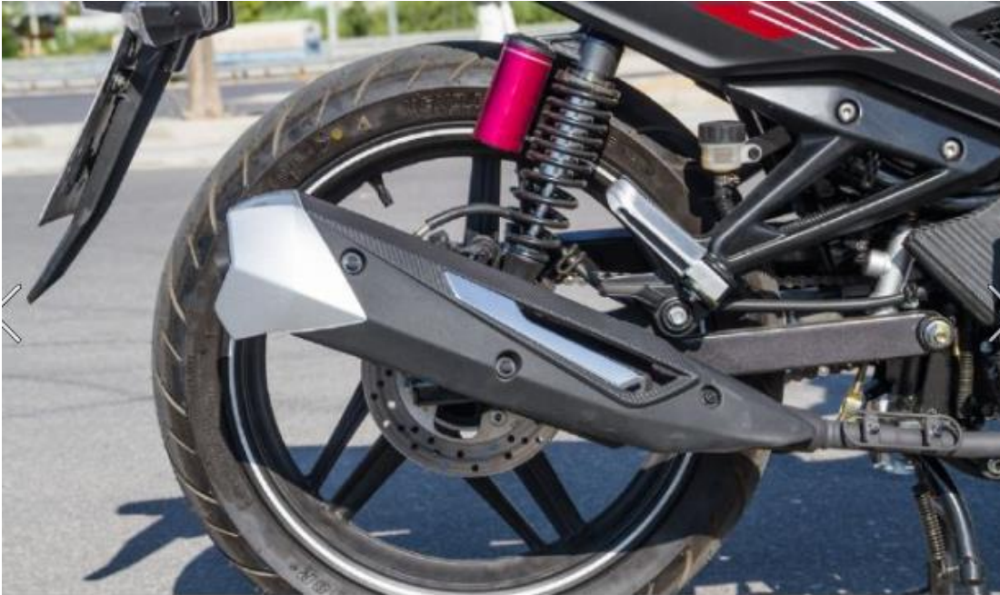
Τα δοχεία αερίου σε κόκκινο χρώμα ξεχωρίζουν, στα δύο ρυθμιζόμενα αμορτισέρ.
