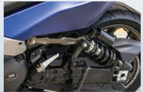
Το πίσω αμορτισέρ με μοχλικό κάνει άψογα τη δουλειά του προσφέροντας πρόσφυση παντού. Διαθέτει δυνατότητα προφόρτισης του ελατήριου με τη ρύθμιση να γίνεται σε όποιο σημείο θέλεις και όχι σε προκαθορισμένες θέσεις.
