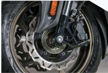
Πλήρως εξοπλισμένο το σύστημα πέδησης με τετραπίστονες δαγκάνες και σωληνάκια υψηλής πίεσης.
